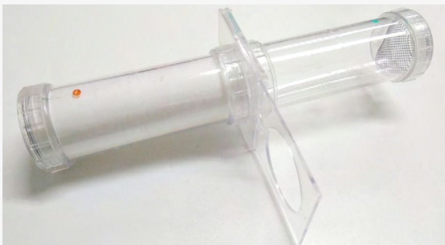
Figura 4. Tubos de mantenimiento y de exposición unidos por la unidad deslizante
