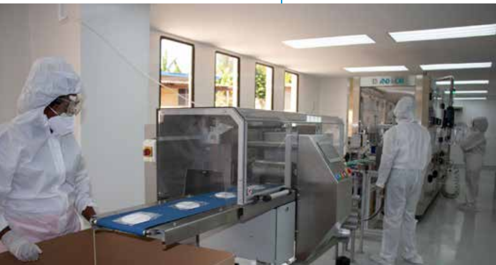
Línea automática de producción y empaquetado de mascarillas FFP2
