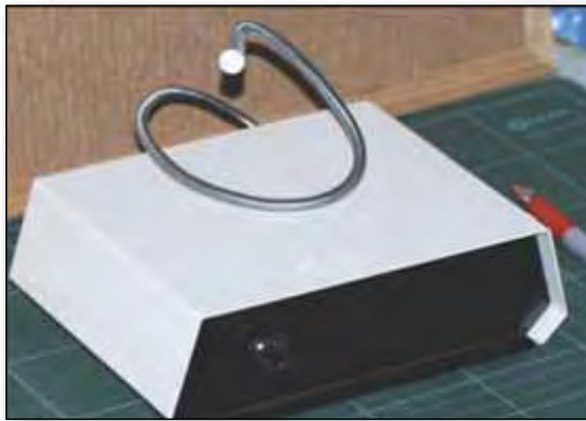
A luz de LED aqui ilustrada funciona por no mínimo 200 horas com quatro pilhas padrão de 1,5 volts.
