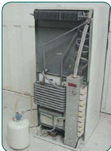
Refrigerador a gas propano
