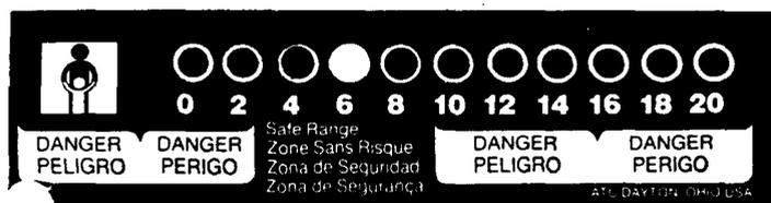
El termómetro PAI que se reproduce arriba está concebido para las refrigeradoras utilizadas en los centros de salud. Es de cristal líquido, resistente al
