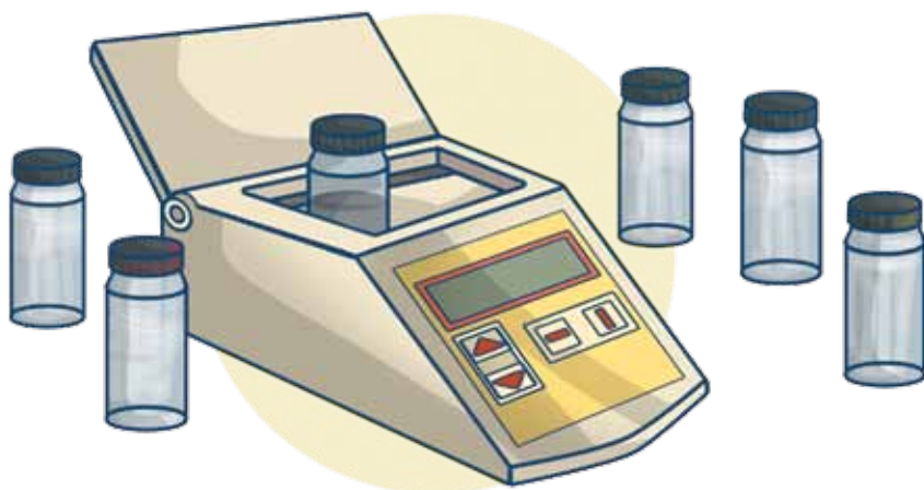
Figura 13. Equipo para medir la turbiedad
