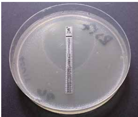
Figura 4.11 Resultados de la determinación de la CIM para N. gonorrhoeae usando Etest. La CIM de penicilina G (PG) se determina en el punto de intersección de la elipse con la tira (0,094 mg/l).
