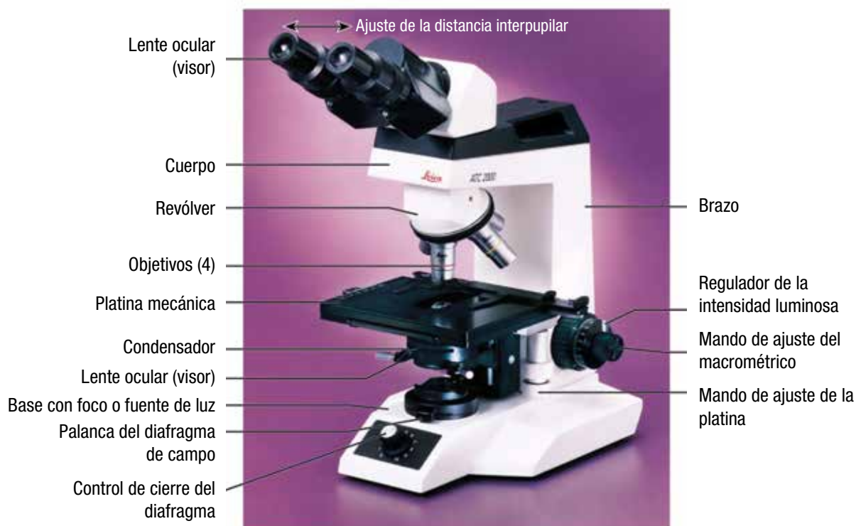
Figura A1.1 Componentes de un microscopio óptico
