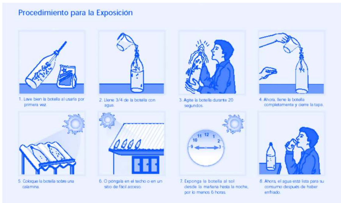
Figura 41. Procedimiento SODIS (OPS/CEPIS/05.170 – UNATSABAR)
