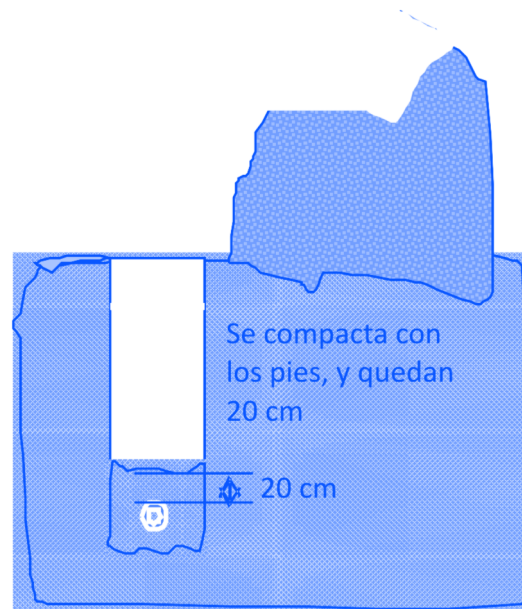
Figura 3. Primera capa de relleno
