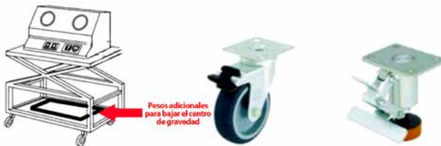
Figura 10: Ejemplos de dispositivos de aseguramiento del material rodante. (Fuente Geohazard, India)
