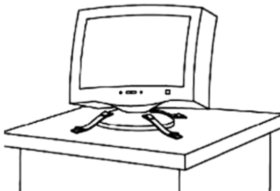
Figura 15: Ejemplo de fijación de un monitor. (Fuente Geohazard, India)
