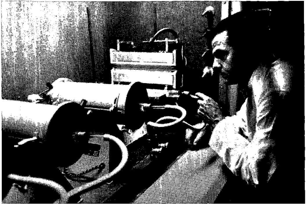
Incineración de un tubo de polietileno para la determinación de negro de humo
