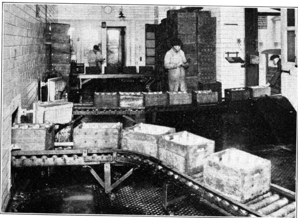
FIG. 8.—Tres conductores automáticos facilitan el despacho directamente de la cámara frigorífica a los repartidores. Los empleados anotan las entregas a cada repartidor.
