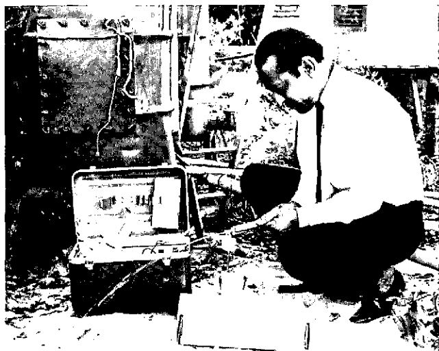
Ingeniero lleva a cabo pruebas bacteriológicas con la técnica de membrana filtrante en experimentos con filtros de arena.
