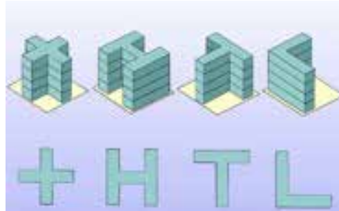
Figura 1. Esquemas de irregularidades en planta.
