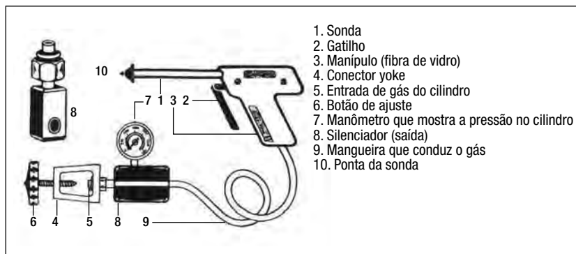
Figura FP5.10.1: Componentes do equipamento de crioterapia
