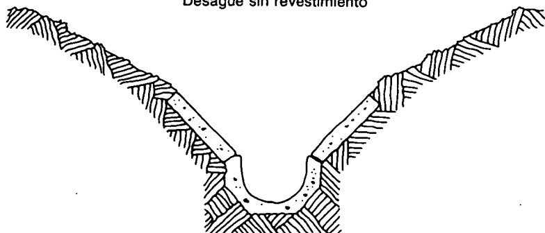
Desagüe parcialmente revestido
