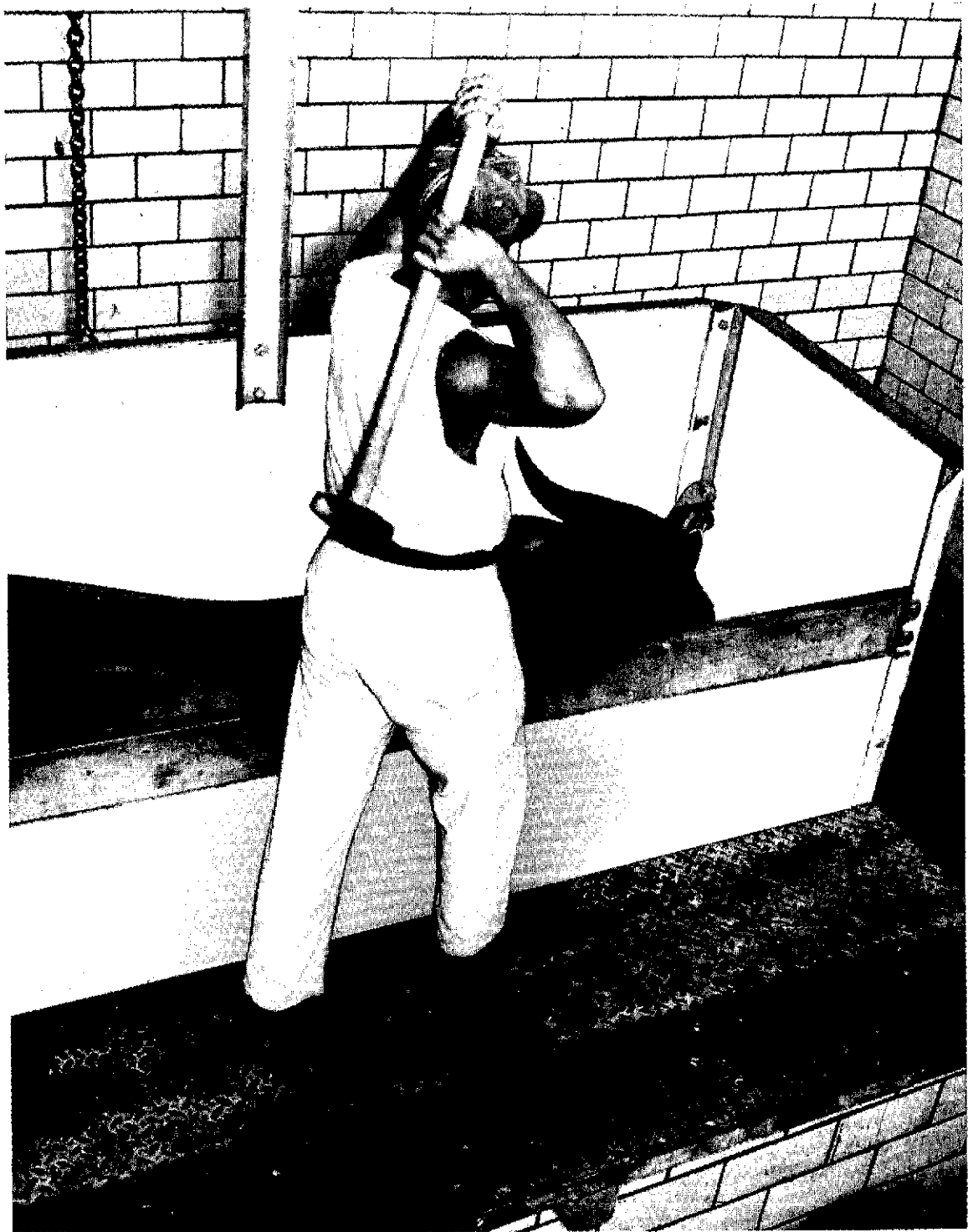
Figura 9. Trampa de sacrificio con unidad completa de metal. Nótese la cadena de la puerta corrediza lateral. El sistema utilizado es conmoción por mazo o comba.
