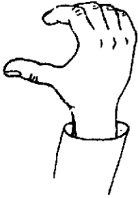
Fig. 66. Determinación del sentido del campo magnético, aplicando la regla de la mano derecha.
