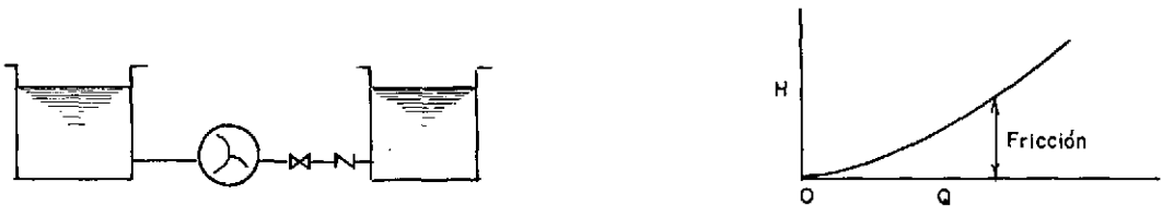
Fig. 192. Curva de columna del sistema cuando la elevación vale cero.
