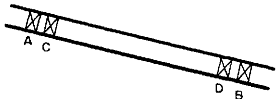
Fig. 152. Instalación adecuada de válvulas.
