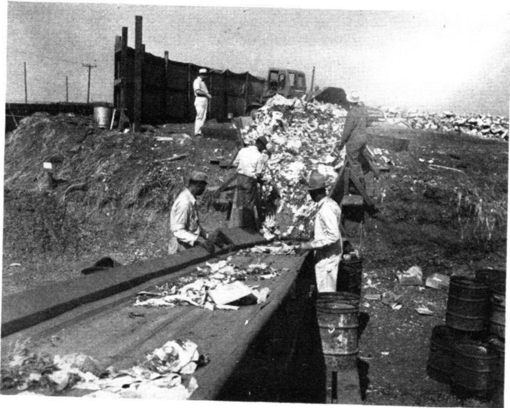
papel, puede hacerse por medio de un soplador que ejerza la succión directamente sobre la correa de transmisión. Las botellas, vidrios y objetos de cerámica son los más difíciles de manipular. El recogerlos a mano no resulta conveniente y la pulverización del vidrio mezclado con la basura crea difíciles problemas de equipo.
